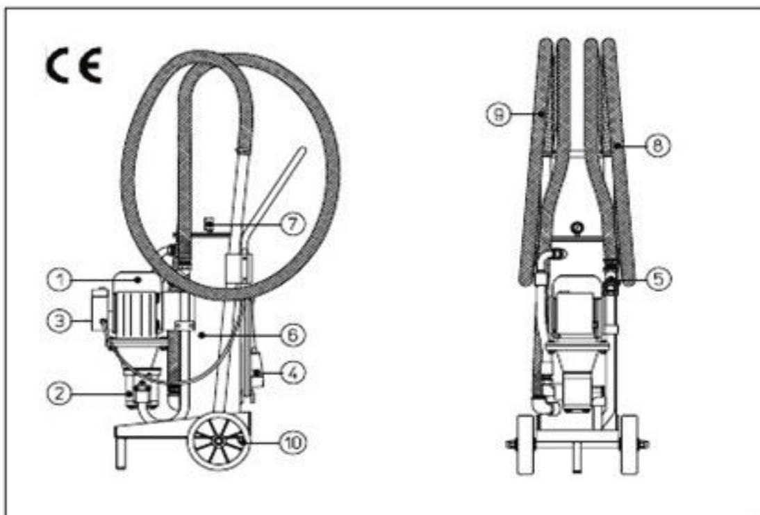
Unità mobile adatta al riempimento, allo svuotamento e rimozione del contaminante (anche acqua) presente nei circuiti e serbatoi idraulici mantenendo la classe di pulizia richiesta.
